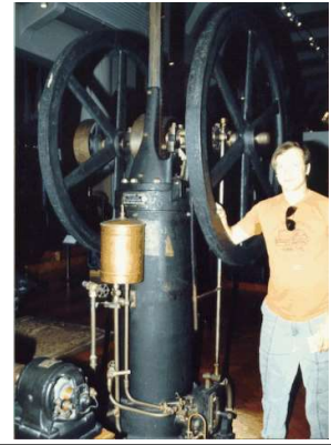
Otto ve Langen'in Paris 1867 fuarında sergilenen serbest pistonlu atmosferik gaz motoru
