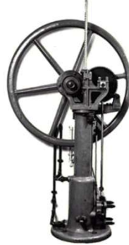
Otto ve Langen'in Paris 1867 fuarında sergilenen serbest pistonlu atmosferik gaz motoru
